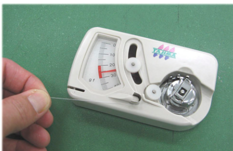
下糸テンション測定ゲージ 品名 : BTG (大釜 / 小釜兼用)
